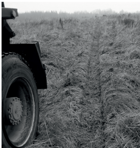
Joonis 2. Roopad pärast efektiivse veojõu mõõtmist nov. 2014 niidetaval rohumaal Kirde-Eestis Kog, k 1 l s 50/r 1 l s mullal
